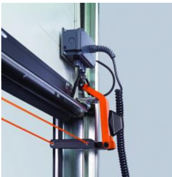
Bild 5: Ein direkt unterhalb der Schliesskante laufender Lichtstrahl (Voreilende Lichtschränke VL2) empfiehlt sich besonders bei Toren mit Schlupftür.
